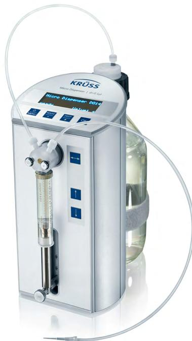
我们专门开发的微型液体分配器专门配备了于 力学法表面张力仪Tensíó, 可使用一或两个分配器单元 (DS1110 和 DS1120) 以最高精度测量临界胶束浓度 (CMC)。设置表面活性剂浓度范围, 然后全自动进行测量。
