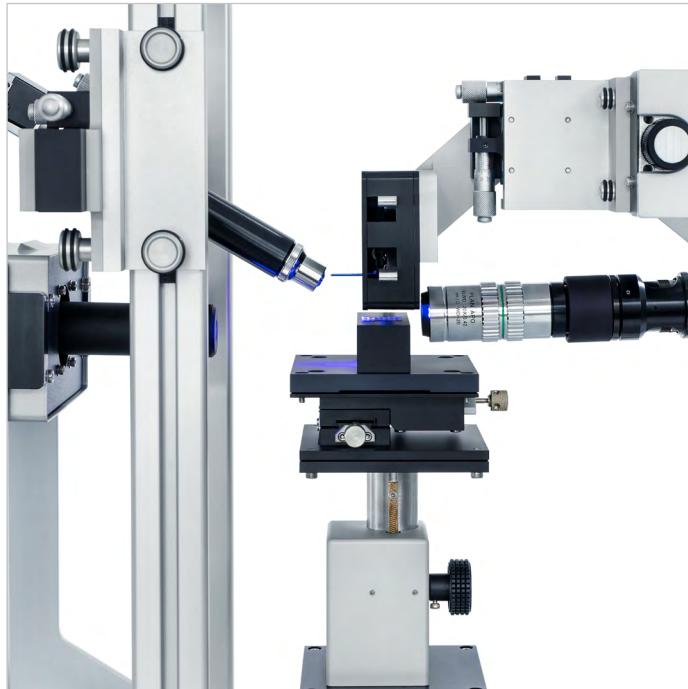
带 Flexible Liquid 微滴定模块的 DSA30
