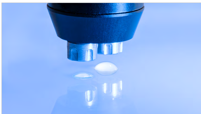
使用液体针头通过两个液滴快速测量表面自由能SFE
