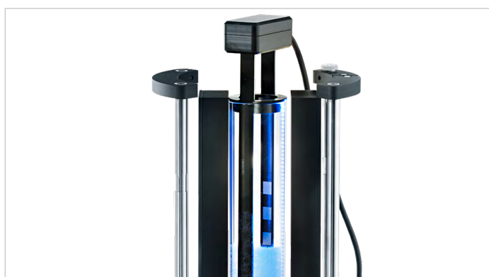
用于分析含液量的电导率传感器
