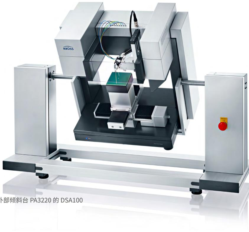
倾斜装置是灵活分析倾斜表面的特殊单元。对液滴变形和导致液滴滚落倾斜度的测量可以得出关于粗糙度和粘附性的结论。滚落角为超疏水样品提供了有用信息，可通过缓慢的倾斜运动进行精确测量。
