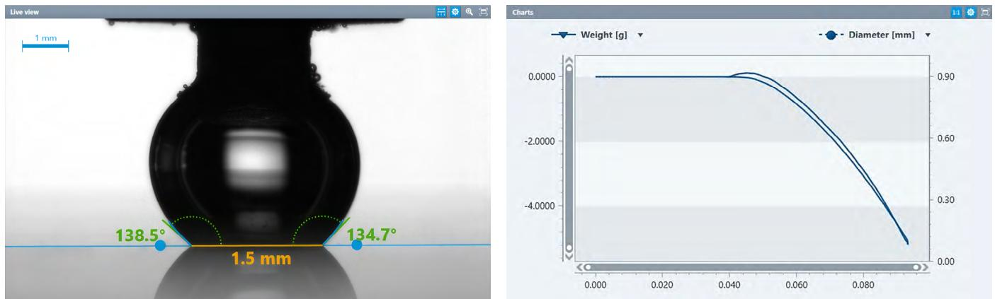
采用视频粘附力分析法测量粘附力：我们的 Tensiio 使用集成相机将力的测量和液滴形状分析（包括接触角）结合起来。
