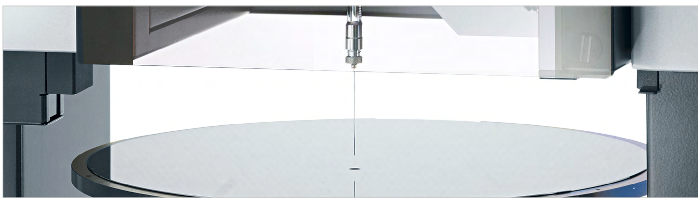
晶片上的全自动液滴定位
