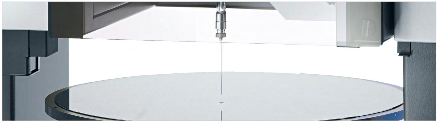
晶片上的全自动液滴定位
