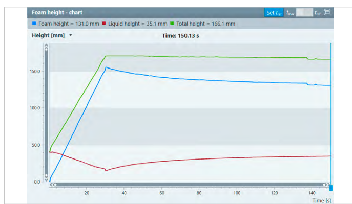
同时获得总高度、泡沫高度和液体高度的测量数据
