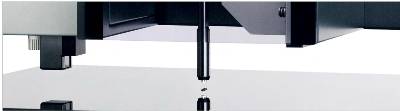
使用可选的液体针头滴定单元，可快速、自动地对表面自由能进行样品映射
