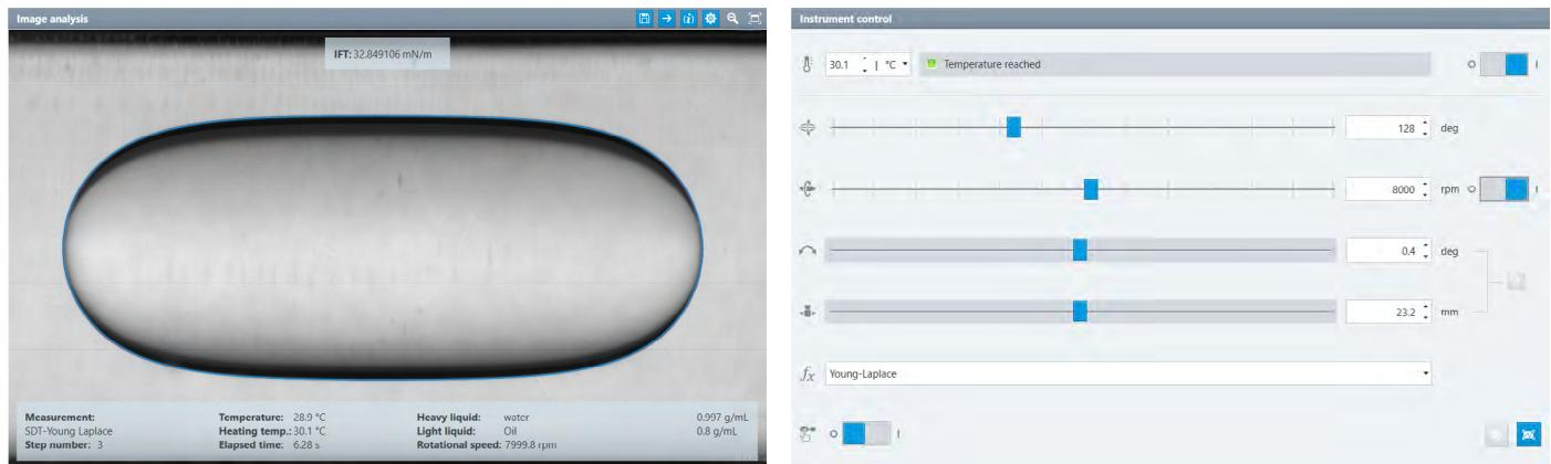
界面张力 (IFT) 测量可精确到非常低的值: 借助我们的 SDT 型旋转滴界面张力仪, ADVANCE 可以分析旋转毛细管中液滴的图像, 使用液滴的直径或曲率来确定 IFT。
