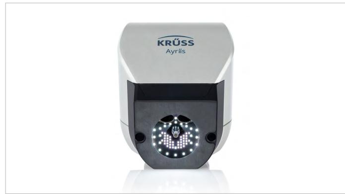
空间狭小的高科技:90个 LED 产生的反射图案,用于水滴的三维模型重建。
