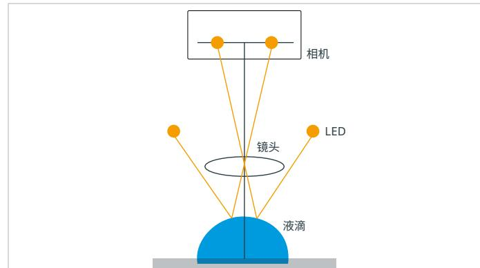
顶视法接触角测量原理
