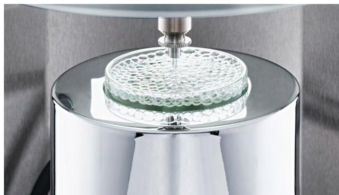
带有集成温控装置的样品台
