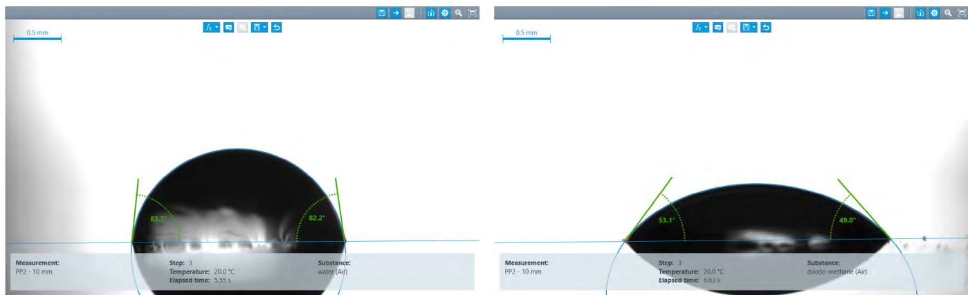
只需单击一下即可测量表面自由能(SFE)：使用我们的液体针头滴定单元，ADVANCE 同时显示和分析两种滴定的液滴。
