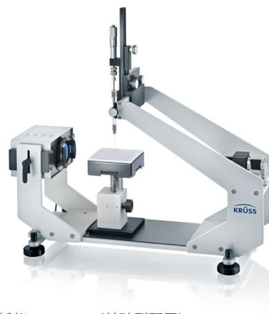
液滴形状分析仪 – DSA25B (基础型配置)
