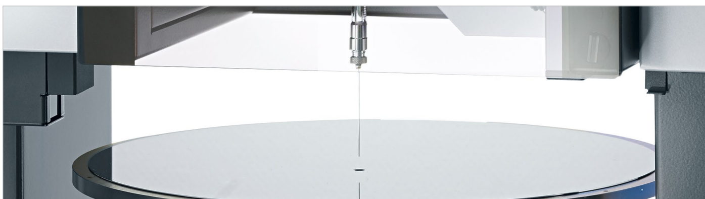
在晶圆上的自动滴液定位
