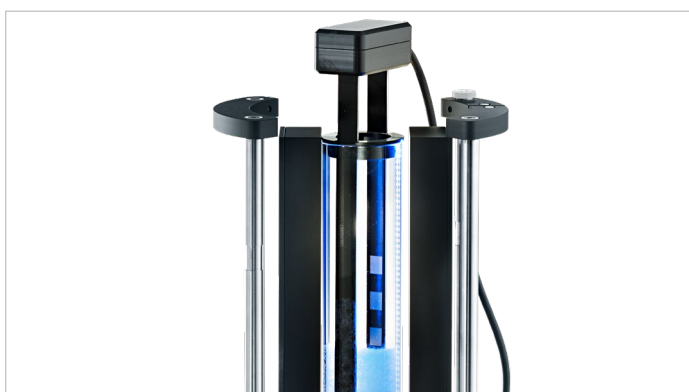
用于分析含液量的电导率传感器
