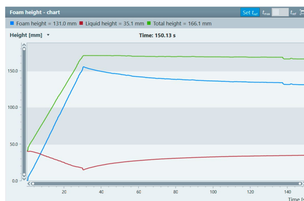
同时获得总高度、泡沫高度和液体高度的测量数据
