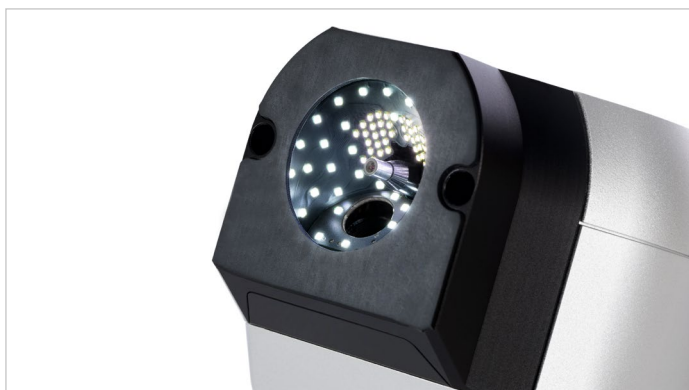
测量头内的滴定口可以滴出精确且可调节体积的水滴。
