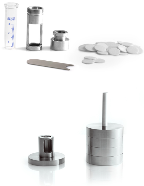
Abb. 2: Washburn-Sorptionszelle und Präparationsset mit Packgewichten
