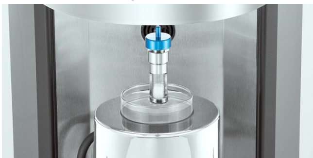
Abb. 4: Die Washburn-Zelle mit der komprimierten Pulverprobe ist mit dem Kraftsensor verbunden
