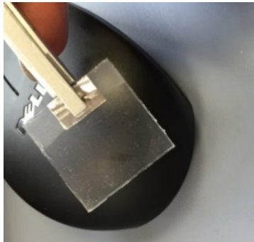
Abb. 2: Haftklebmasse mit 12% Acrylsäuregehalt auf Deckgläschen an einem SH0601 Klemmprobenhalter für das K100 nach Messung in Wasser
