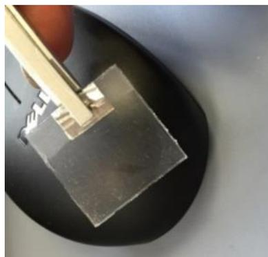
图 2: 丙烯酸含量为 12%的粘合剂用 K100 的 SH0601 夹钳样品架在水中测量后的盖玻片
