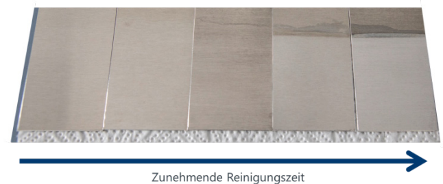
Abb. 2: Foto von Stahlblechen nach Reinigung mit aufsteigender Reinigungsdauer von links nach rechts
