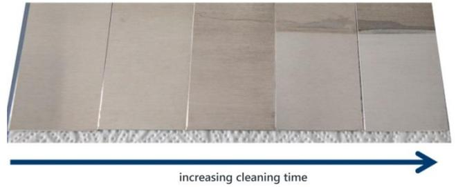
图 2: 从左向右清洁后钢板的照片, 清洁时间逐步延长在所检查的样品中, 样品的水接触角度从原来的 90° 下降到 13°。这是因为脏污并不溶于水。
