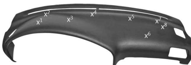
图 3: 仪表板样本盖的示意图。在每种情况下，都在八个位置进行测量，在此处进行相应标记。
